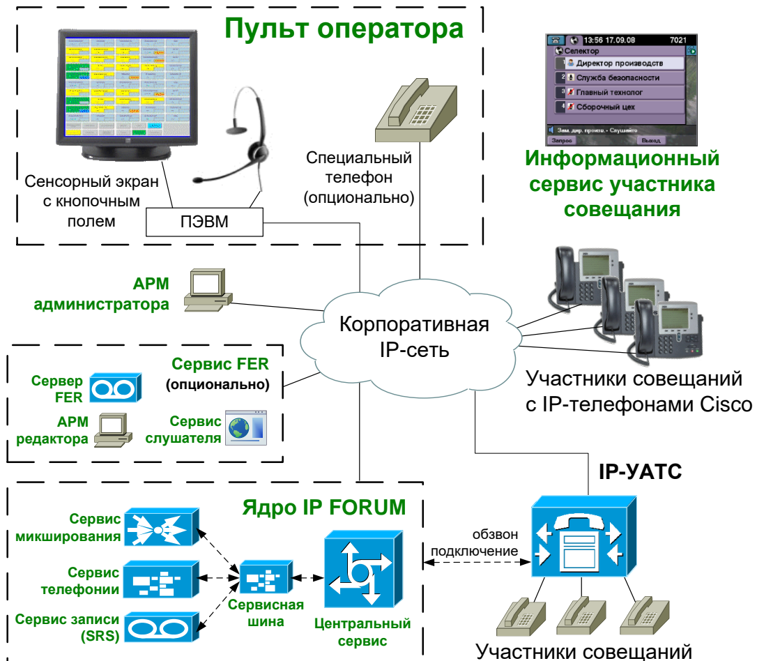
Рисунок 1 – Архитектура аппаратно-программного комплекса IP FORUM
