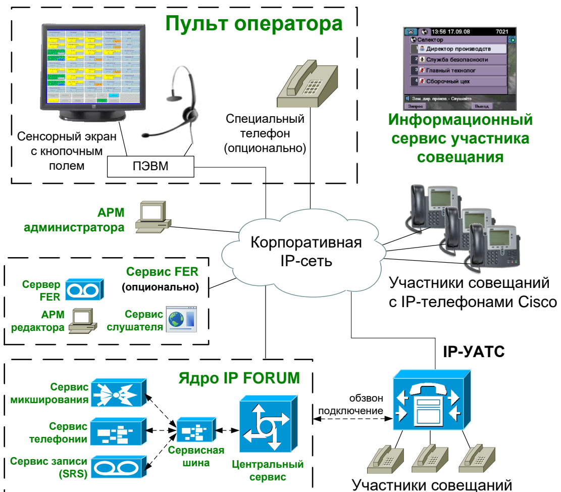
Рисунок 1 – Архитектура аппаратно-программного комплекса IP FORUM
