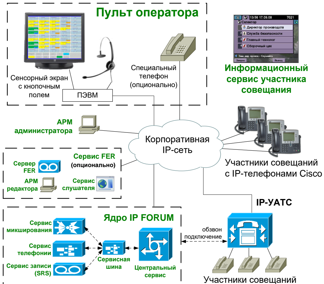
Рисунок 1 – Архитектура аппаратно-программного комплекса IP FORUM
