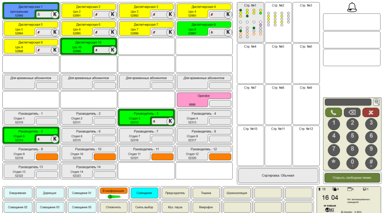
Рисунок 2 – Раскладка кнопочного поля пульта типа SMALL (редакция SE)
